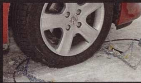
Passez l'embout coloré derrière la roue, en prenant garde qu'il glisse librement.
