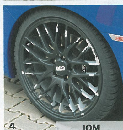
1.-4. Foliatic, Starpaint, Raid und Jom (von oben nach unten). Am ehesten konnte Foliatic überzeugen. Überraschend: Beim vergangenen Test überstanden die Beschichtungen schadlos über ein Jahr. Hier das Ergebnis nach knapp 5.000 Kilometern
